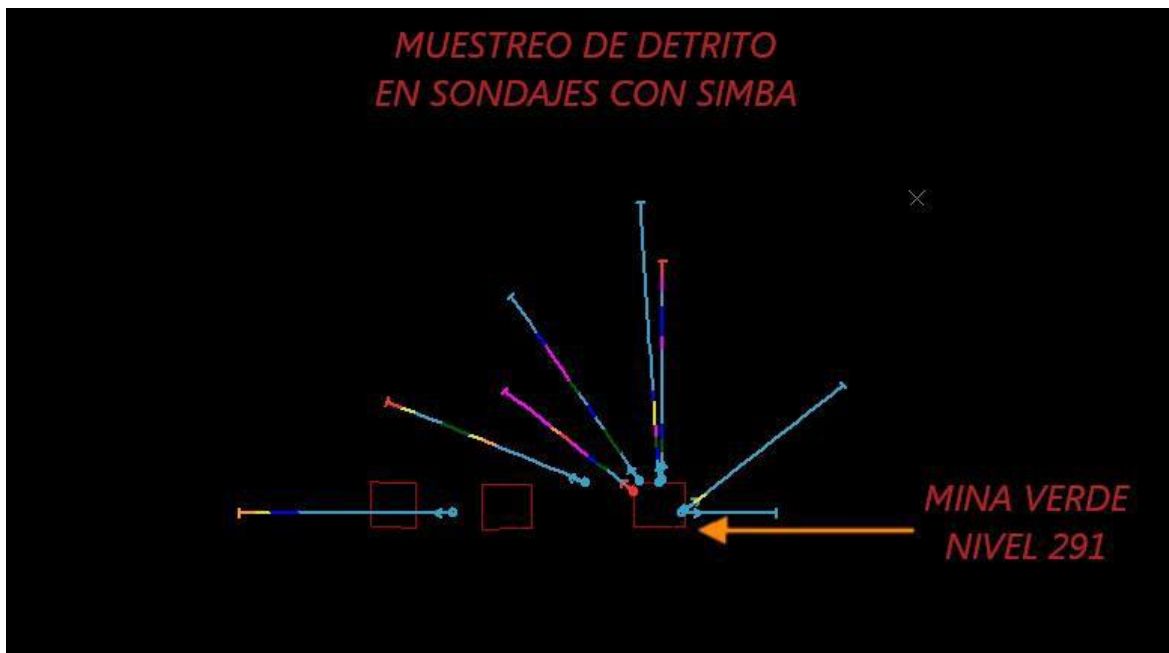
Ilustración 6. Muestreo de barros de perforación en tiros de producción.
